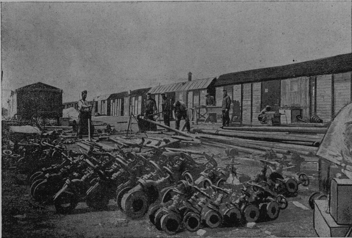
Iz zasedene Rumunije: Avstro-ogrski delarnski vlak. Posamezni vagoni so delarne za tesarje, kleparje, kovače i. dr. s stroji posameznih strok.
