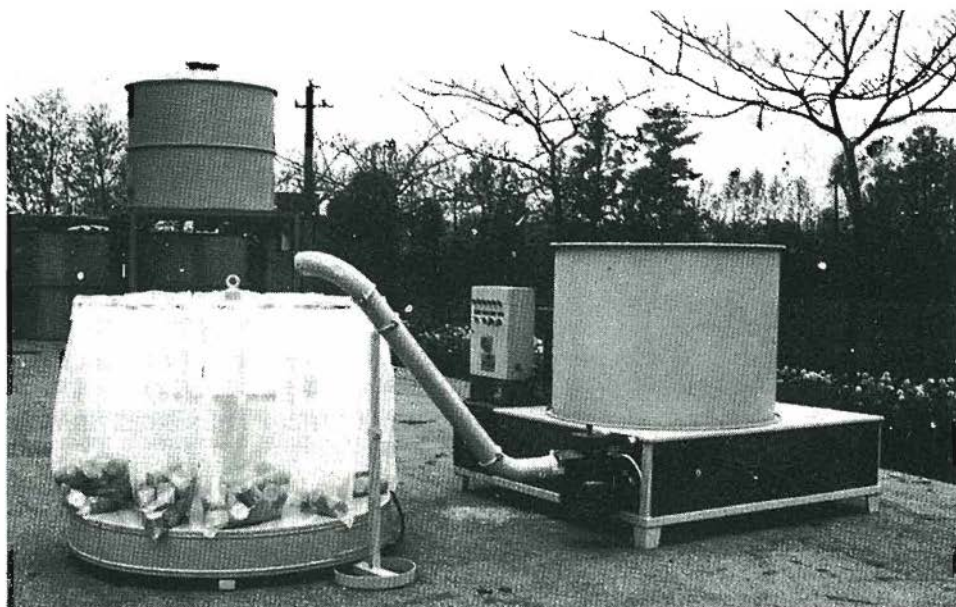
Sl. 2: Briketirna naprava zmogljivosti 25–120 kg/h, proizvodnja: Sacmé Mirbo, Francija (vir: prospekt proizvajalca).
