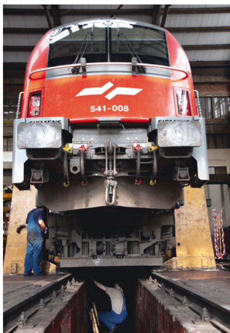
Demontaža pogonskih sklopov (foto: Miško Kranjec)
