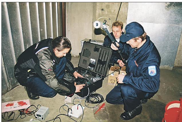
Delo z napravo za iskanje preživelih izpod ruševin z globinsko TV kamero in mikrofonom
