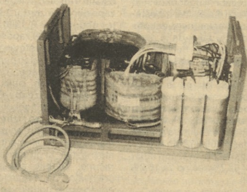
UIS — ultraizolacijski stabilizator se uporablja za zaščito občutljivih elektronskih naprav
