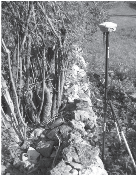
Slika 10: Primer neskladnosti podatkov med skico meritve in resničnim stanjem na terenu. Na skici je mejnik vrisan na desni strani zidu, v naravi je stabiliziran na levi strani, po koordinatah je prav tako na desni strani zidu.
