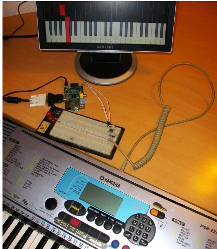
Slika 39. Povezava med klavirjem in mini računalnikom Raspberry Pi
