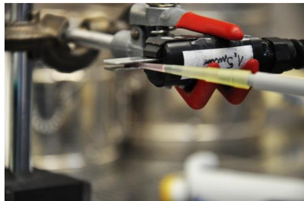
Slika 43. Pipetiranje kapljice med elektrodi za elektroporacijo.
