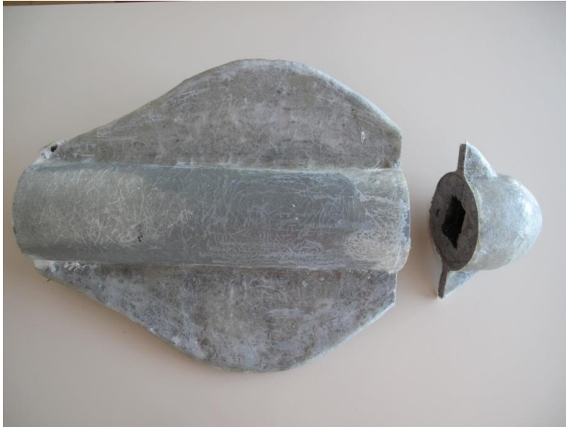
Slika 2: Model notranje lupine prevlečene s steklenimi vlakni.
