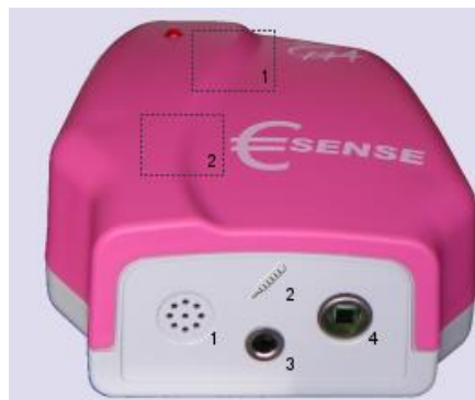
Slika 1: Vmesnik €Sense: Številke pomenijo: 1 zvočni senzor, 4 svetlobni senzor in 3 priključek za zunanji temperaturni senzor.
