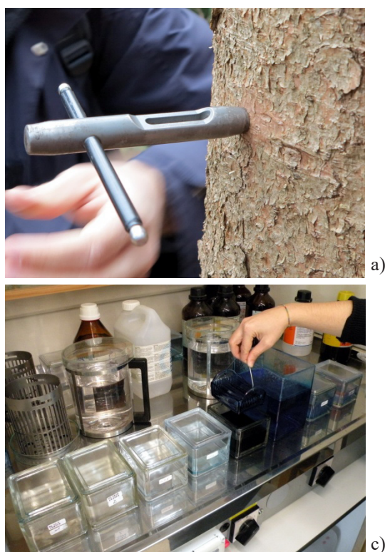
Slika 4: Odvzem vzorcev in izdelava anatomskih preparatov: a) odvzem mikro-izvrtka z orodjem Trephor; b) izvrtke, vklapljen v parafinski blokec pred rezanjem; c) odstranjevanje parafina in barvanje preparatov; in d) vklapljanje anatomskih rezin v Euparal (Foto: Merela M. in Habjan P.)
