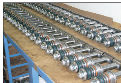
Hidravlični valji pred montažo
