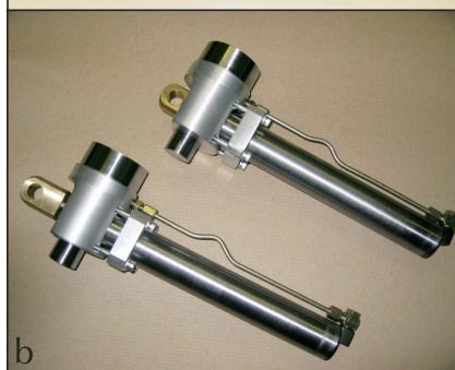
Hidravlični valj: a – za visoke tlake, b – za letalsko industrijo
