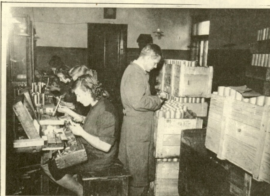
Oddelek za izdelovanje cinkovih čaš po letu 1953. V lesenih zabojih, ki so bili tedaj skoraj edina transportna embalaža, so velike čaše za okrogle elemente. Na levi v ospredju pa delavka spaja čaše tudi za ploščate baterije 3R 12, takrat imenovane BD.
