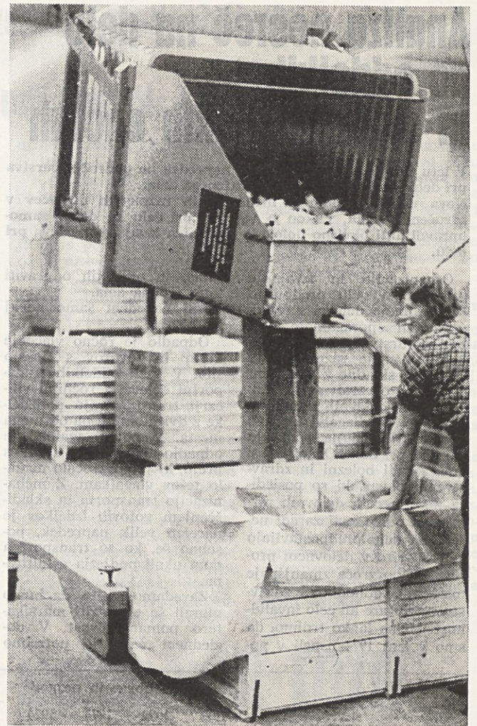
Vlagalka s pomočjo lopute stresalnika stresa kopse v zaboj. Nič več dvigovanja 30 kg košar!
