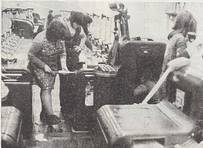
Vodja je dolžan zagotoviti varnost čistilk in stroj na zanesljiv način izločiti iz obratovanja pred čiščenjem.
