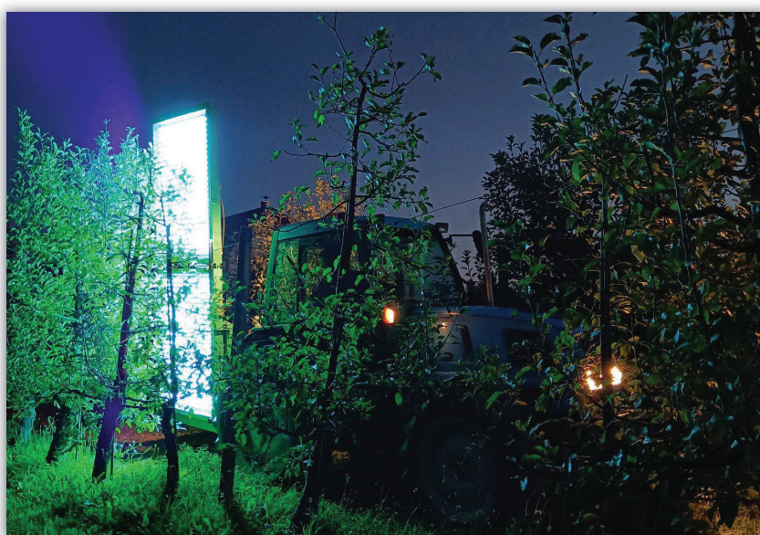
Slika 6: Prikaz uporabe traktorskega priključka za UV-C osvetljevanje v nasadu jablan (praktični preizkus v okviru projekta UV4PLANTS)
