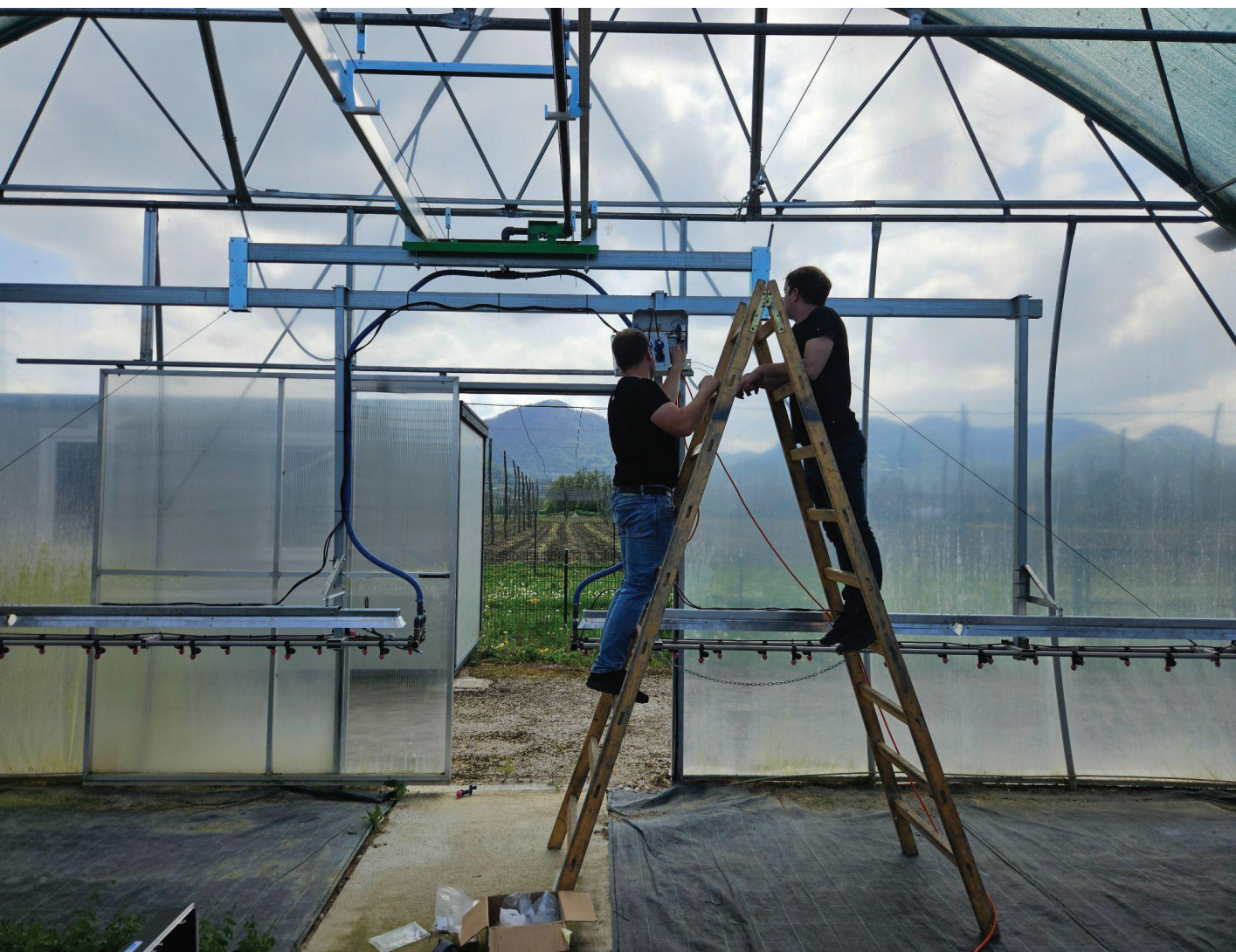
Slika 8: Sistem za UV-C osvetljevanje na premični rampi v rastlinjaku Inštituta za hmeljarstvo in pivovarstvo Slovenije.
