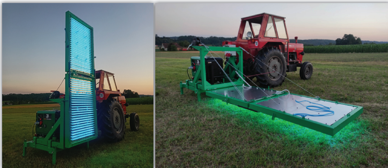
Slika 5: Traktorski priključek za UV-C osvetljevanje razvit in izdelan v okviru projekta UV4PLANTS
