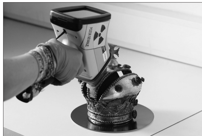
Slika 4: Naravoslovne preiskave z rentgensko fluorescenčno spektrometrijo XRF (foto: Blaž Gutman, 10. 6. 2021).
