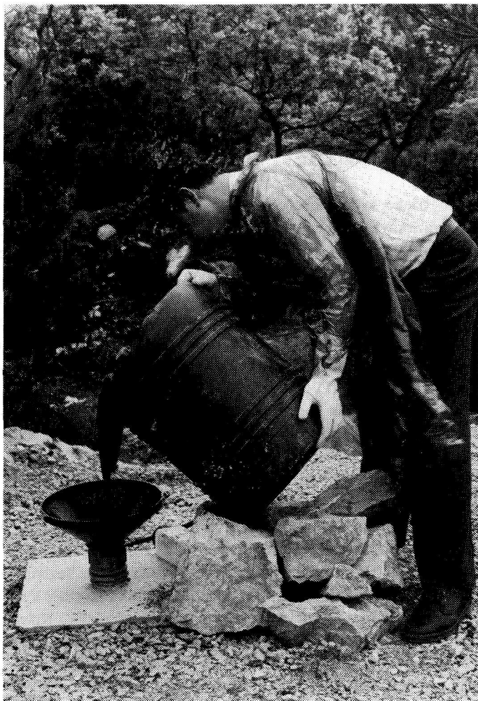
Sl.11 Injiciranje uranina v vrtino v zaledju izvira Rižane
