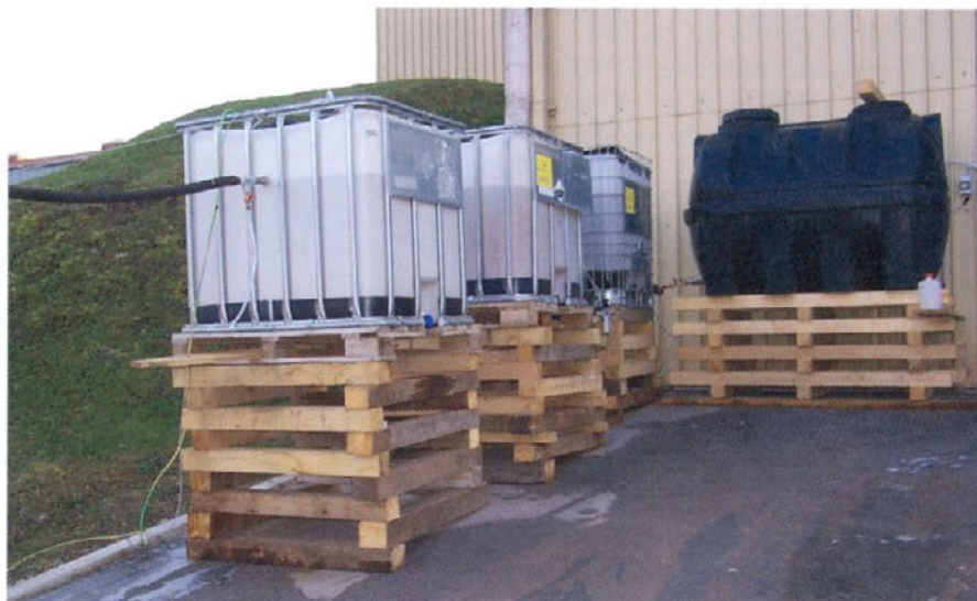
Pilotna naprava, ki simulira delovanje čistilne naprave z mikroorganizmi.
