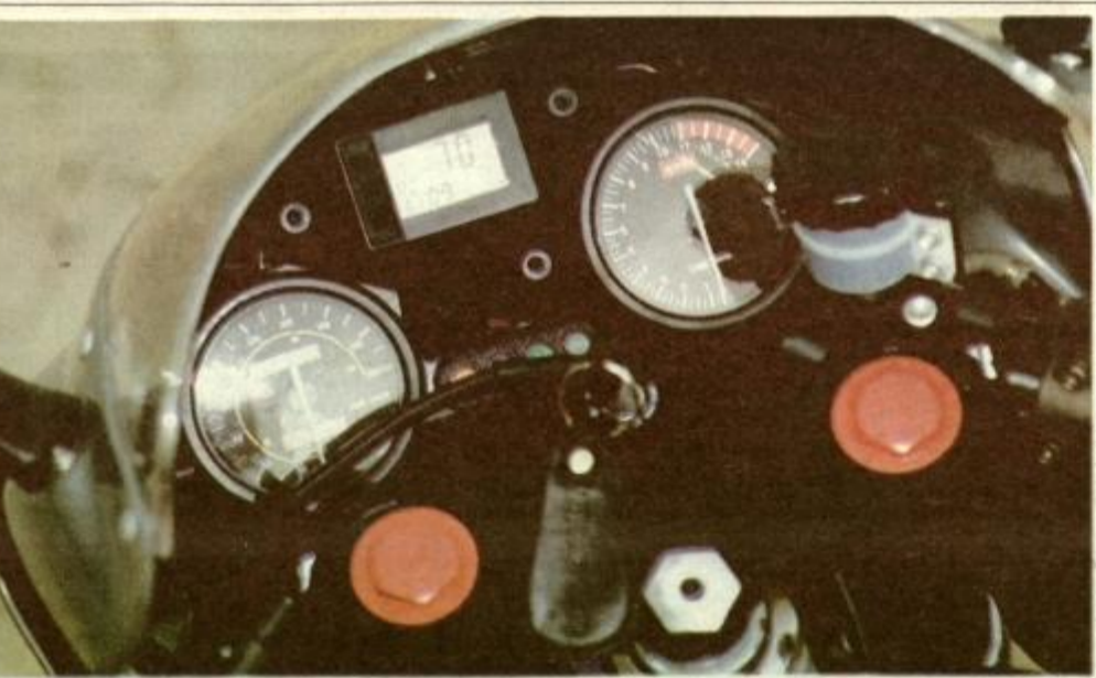
Supersportnik: dominanten merilnik vrtljajev, digitalni merilnik temperature vode, napetosti akumulatorja, stoparica in ločen rezervoar zavorne tekočine.
