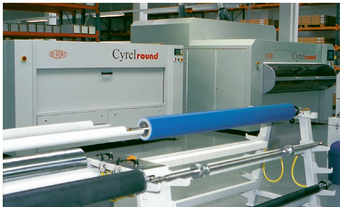
Slika 33. Naprave za digitalno kopiranje brezšivnih tiskarskih valjev za fleksotisk v podjetju Repro Busek na Dunaju.
