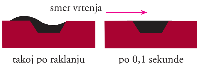
Slika 22. Prenašanje tiskarske barve na rastrski valj pri doziranju z raklanjem.
