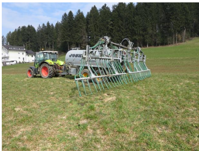
Slika 8: Pri gnojenju z vlečenimi cevmi zmanjšamo površino gnojevke, iz katere izhlapevajo NMVOC-i.
