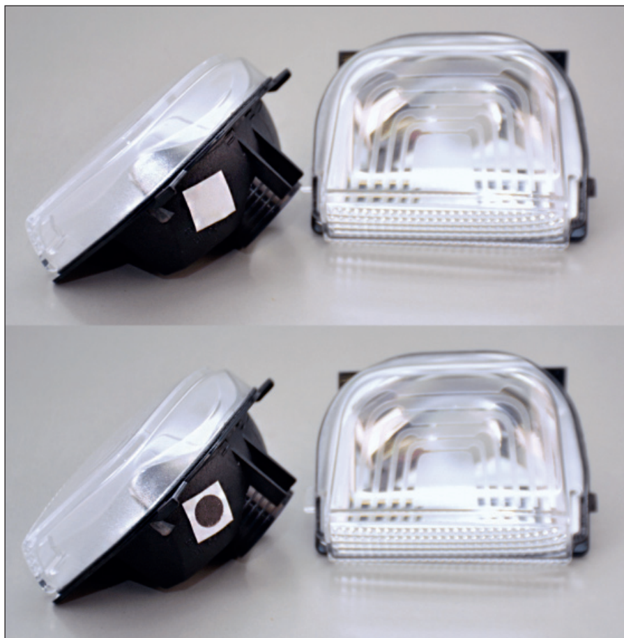
Temperaturni indikator za nadzor termičnega popuščanja pri lepljenju plastičnih ohišij žarometov pred segrevanjem in po njem (arhiv MyCol). / Temperature indicator for controlling thermal tempering when adhering plastic headlight housings before and after heating (archive MyCol).
