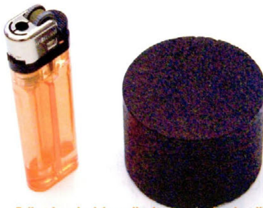
Briket iz velenjskega lignita – po karbonizaciji pri 750°C je njegova kurilna vrednost za 85% večja (18.500 KJ/kg oziroma 36.300 KJ/kg brez vlage in pepela).
