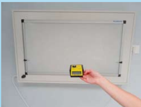
Slika 3: Primer merjenja osvetljenosti prostora na razdalji 30 cm od površine negatoskopa.
