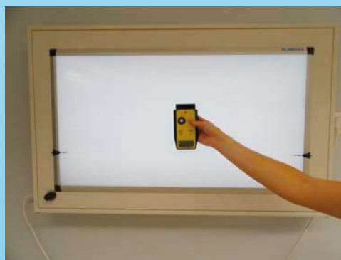
Slika 2: Primer merjenja svetilnosti negatoskopa.
