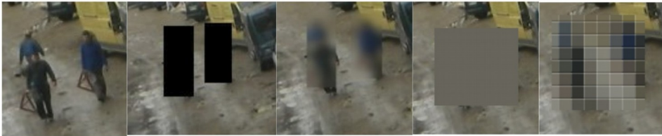
Slika 2: Tehnike zakrivanja (od leve proti desni): originalna slika, zapolnitev s črno barvo, zameglitev, poprečje barv in "Pixelization"
