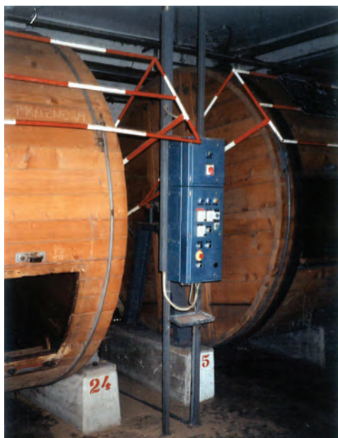
81. Soda za vlaženje usnja s predelano elektro-omaro za upravljanje stroja. Avtor fotografije neznan. Okrog leta 1992. Fotografijo hrani Tone Rožmanc.
