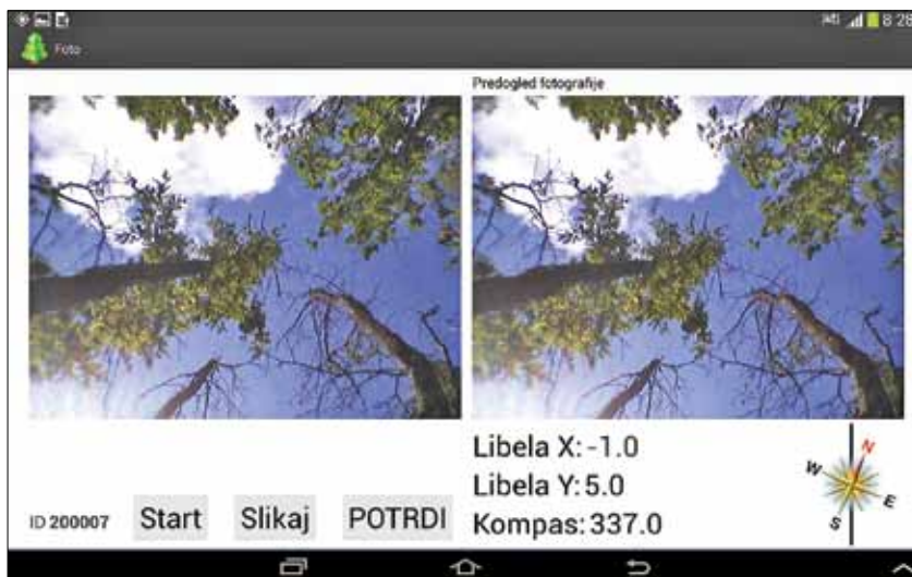
Slika 5: Obrazec za zajem fotografije krošenj iz žabje perspektive. Na levi strani je živa slika kamere, na desni pa predogled zajete fotografije. Na desni strani spodaj sta kompas in libela za pomoč pri orientaciji fotografije. Figure 5: Form for capturing photos of canopies from frog-perspective. There is a live image by camera on the left and preview of the captured photo on the right. Below on the right side there are compass and spirit level to help with photo orientation.
