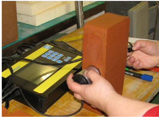
Slika 4.17: Meritve časa prehoda UZ na opečnih zidakih Fig. 4.17: Measurements of ultrasonic transition time through brick units
