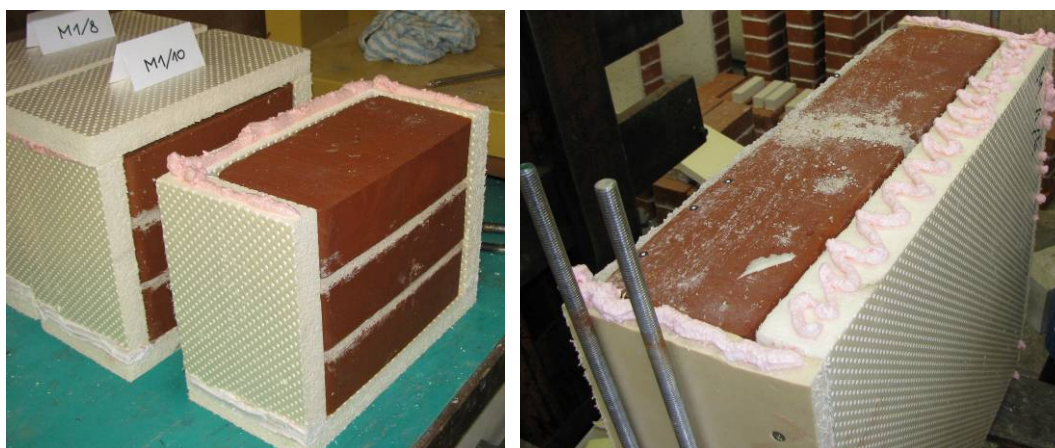
Slika 4.9: Izvedba toplotne zaščite opečnih trojčkov (levo) in opečnega zidka (desno) Fig. 4.9: Execution of thermal insulation of brick triplets (left) and brick wallets (right)
