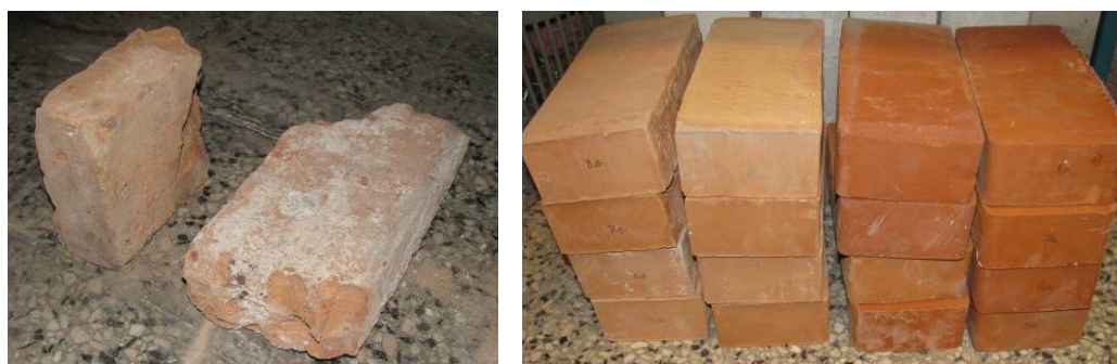
Slika 4.1: Opečna zidaka iz Kolizeja (levo) in polni opečni zidaki normalnega formata vrste b in a (desno)
