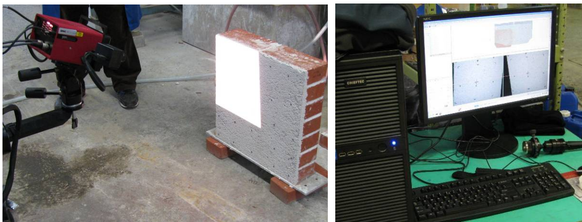
Slika 4.12: Izvedba meritev s 3D skenerjem ATOS I Fig. 4.12: Measurements with a 3D scanner ATOS I
