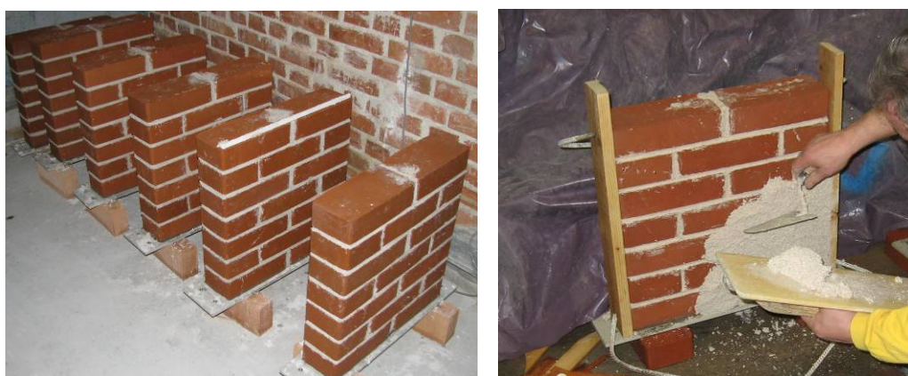
Slika 4.3: Rezultat zidarskega delovnega dne (levo) in ometavanje zidu po 4 mesecih staranja (desno)
