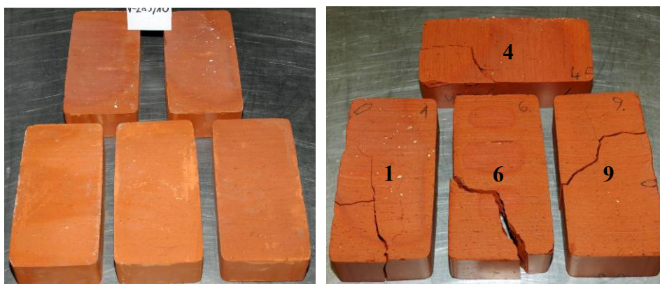
Slika 4.7: Opečni zidaki pred (levo) in poškodbe zidakov po 13–ih ciklih zmrzovanja/tajanja po »JUS postopku« (desno)
