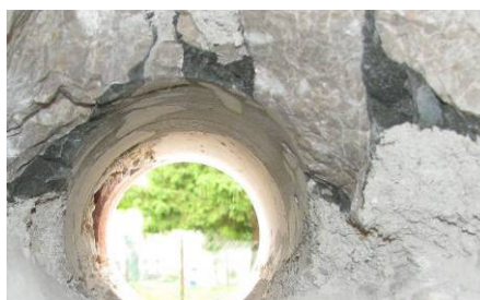
Slika 5.31: Jedro in globinska sonda, izvedena na osrednjem delu zidu 1-C1 Fig. 5.31: Core and in-depth probing in the middle of the wall 1-C1
