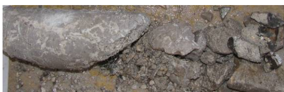
Slika 5.30: Jedro in globinska sonda, izvedena ob vpetju zidu 1-C1 Fig. 5.30: Core and in-depth probing at the bottom of the wall 1-C1
