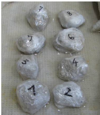
Slika 5.4: Izvedba in rezultati preiskave kapilarnega srka vzorcev malte
