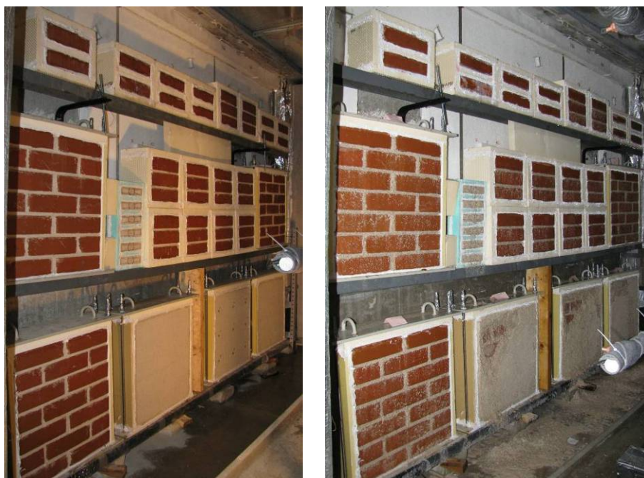
Slika 4.11: Preskušanci M1 pred začetkom (levo) in po 50 ciklih zmrzovanja/tajanja (desno) po »EN postopku«
