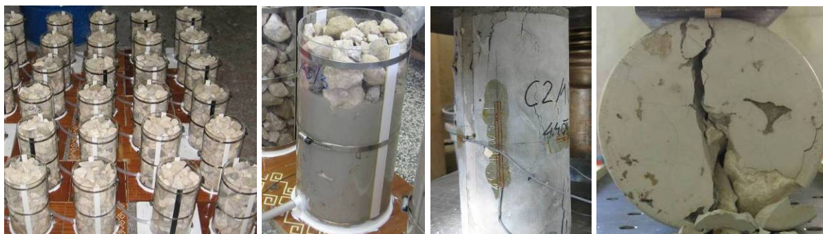
Slika 5.8: Iz leve: preskušanci pripravljene za injektiranje, izvedba injektiranja, preiskava tlačne trdnosti, preiskava cepilne natezne trdnosti
