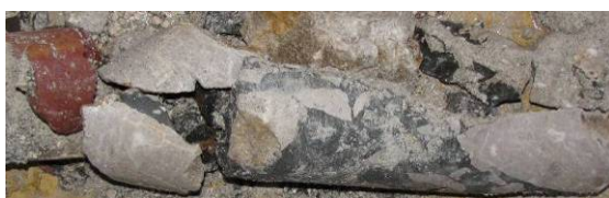
Slika 5.31: Jedro in globinska sonda, izvedena na osrednjem delu zidu 1-C1 Fig. 5.31: Core and in-depth probing in the middle of the wall 1-C1
