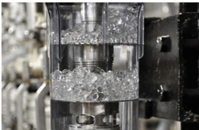
Slika 25: Filtriranje vodke skozi kamene strele Vir: Augustine 2016
