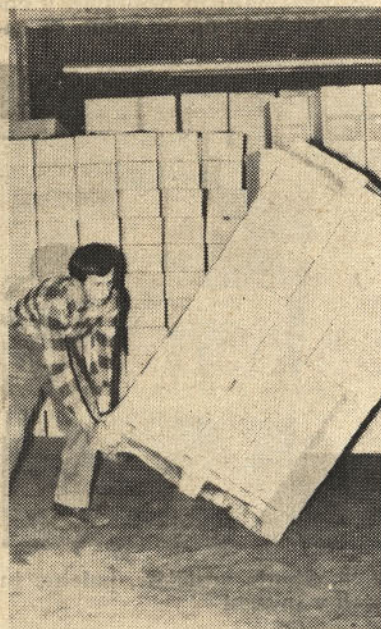
Po vezavi postane paleta zelo stabilna — slika to nazorno prikazuje
