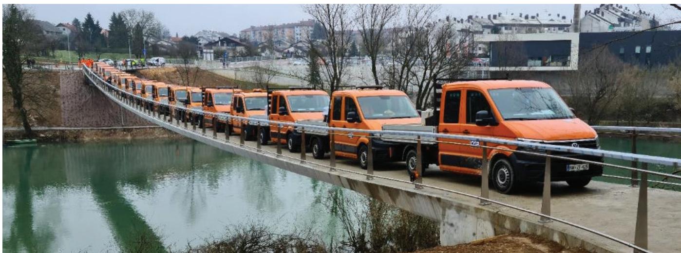
Slika 25. Maksimalna obremenitev z 18 vozili med obremenilno preizkušnjo.
