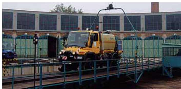
Dvopotno vozilo za zatiranje rastja na železniški progi.
