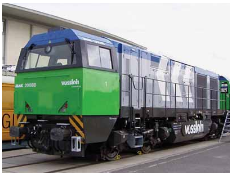
Dizelhidravlična lokomotiva Vossloh G2000 BB, predstavljena na sejni Innotrans v Berlinu.
