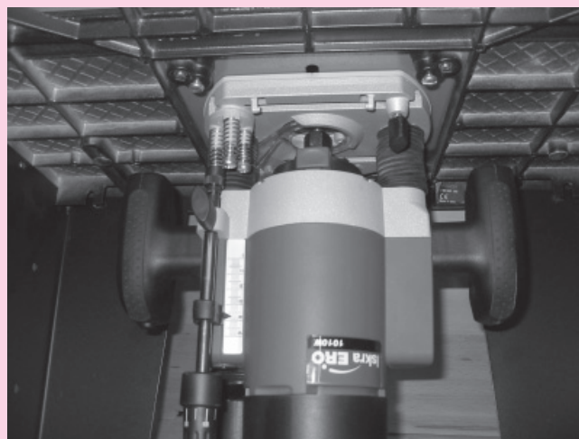
Slika 4. Rezkanje utora z rezkalnikom pritrjenim v delovno mizico
