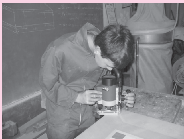
Slika 7. Obdelava mizne plošče oblepljene z ultrapasom
