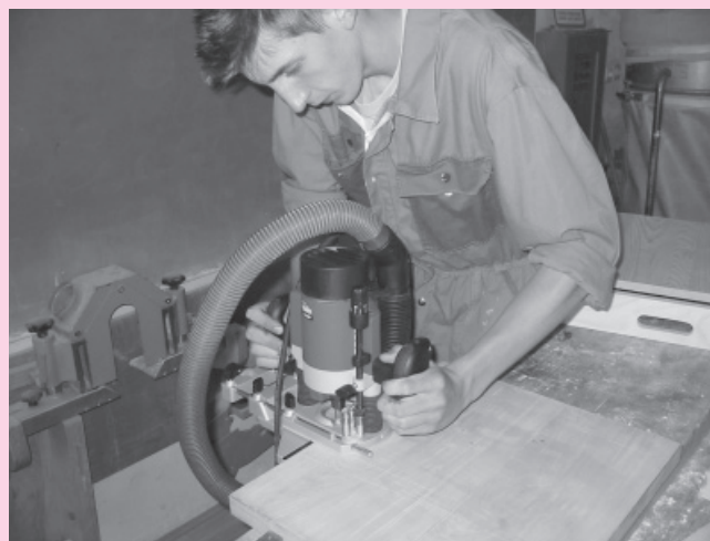
Slika 5. Odsesovalna cev je zgoraj in ne ovira dela
