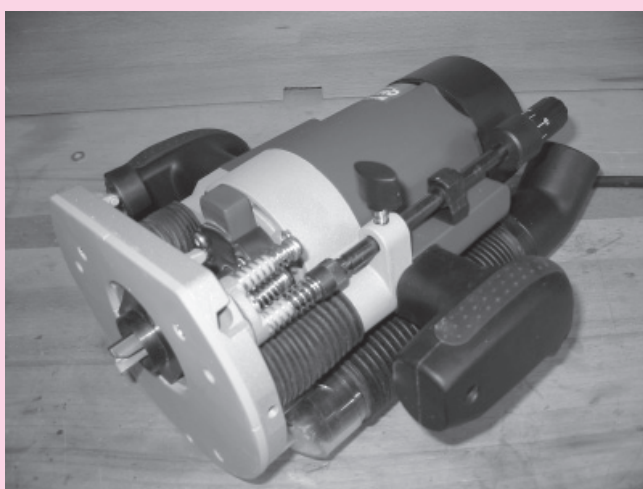
□ Slika 2. Nekoliko drugačna mizica, z vstavljenim distančnim obročem in sistem nastavitve globine
