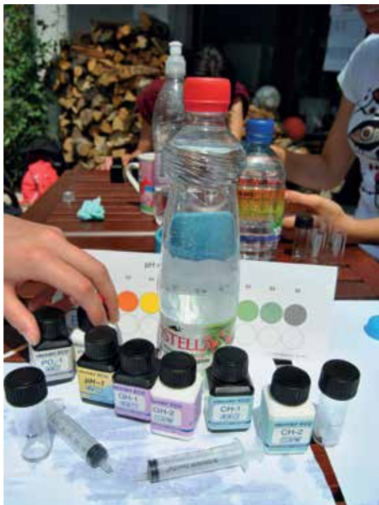
Slika 11: Vpogled v kemijsko stanje vodnih virov s hitrimi kolozimetričnimi testi (foto: Arhiv Oddelka za geografijo UP FHŠ)
