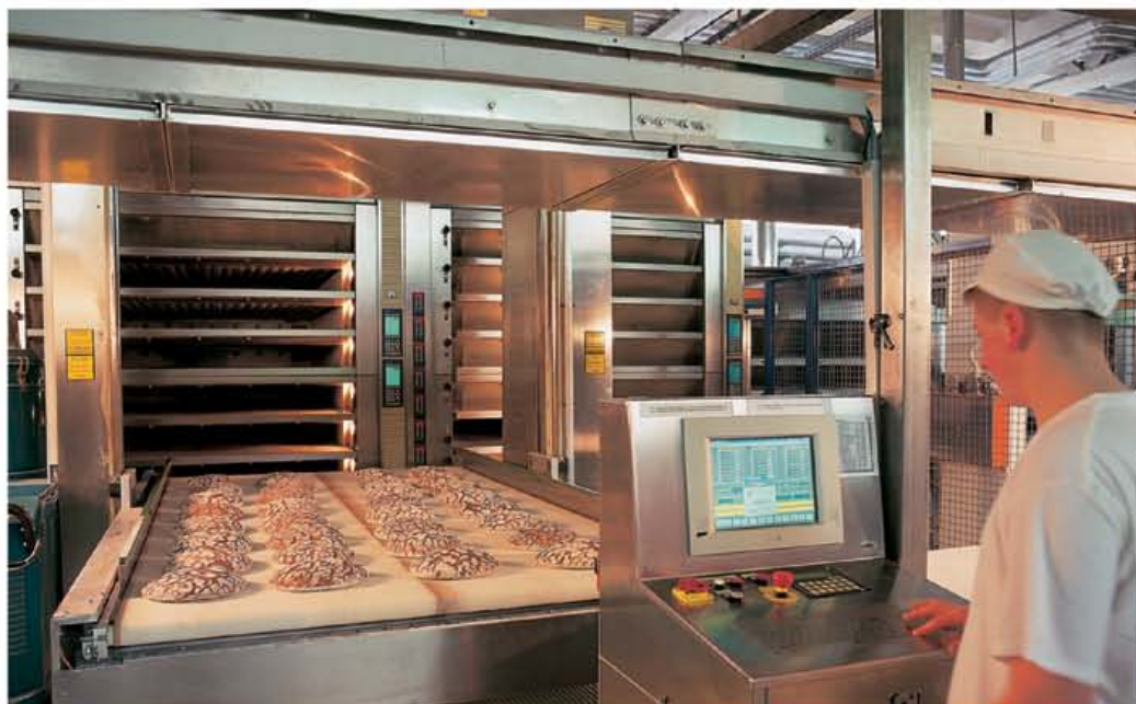
Koroški kruh na sodobnem avtomatu za polnjenje in praznjenje, ki je olajšal delo pekov (8-etažna računalniško krmiljena peč, leto 1999).
