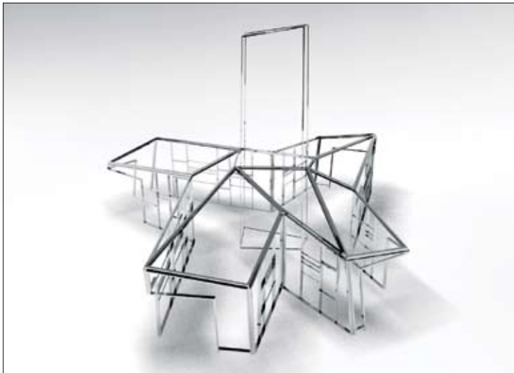
Slika 4: Konstrukcija aluminijastega skeleta paviljona (konstruiranje: RPS)
