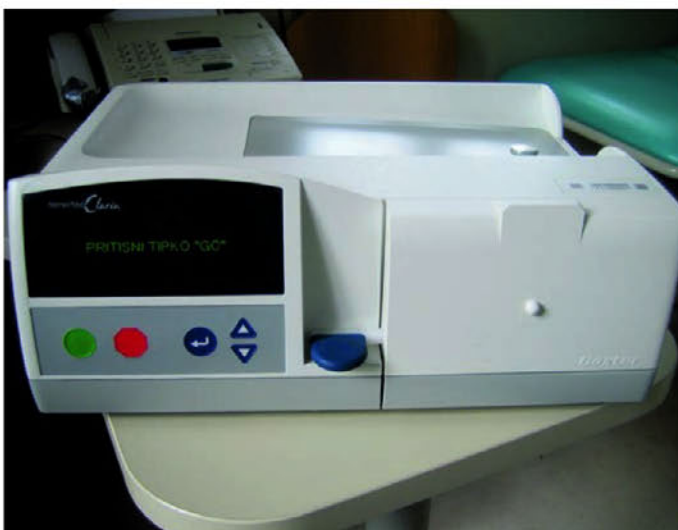
Aparat za avtomatizirano peritonealno dializo na daljavo Homechoce Claria s pomočjo platforme Sharesource
