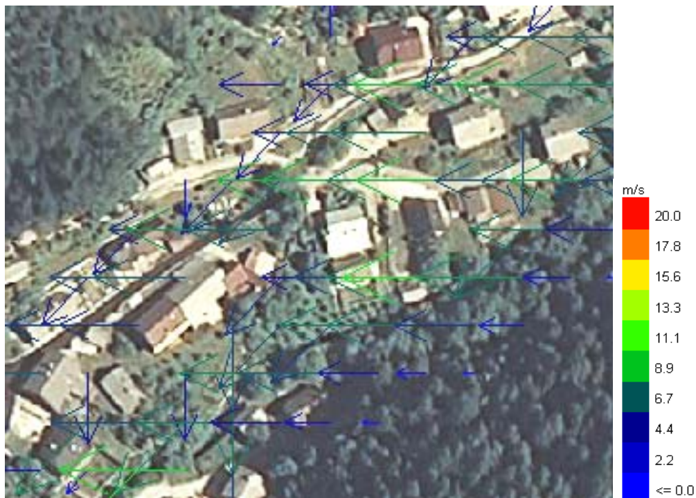
Slika 113: Podrobnejši prikaz maksimalnih hitrosti (vektorski prikaz) v zgornjem delu vršaja, pri modelu Bela56 (parametri: glej sliko 111).
