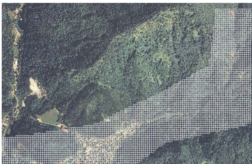
Slika 97: Nova podaljšana mreža 15 m x 15 m pri novem modelu. Fig. 97: New, prolonged, computational grid 15 m x 15 m on upper part of Bela fan.
