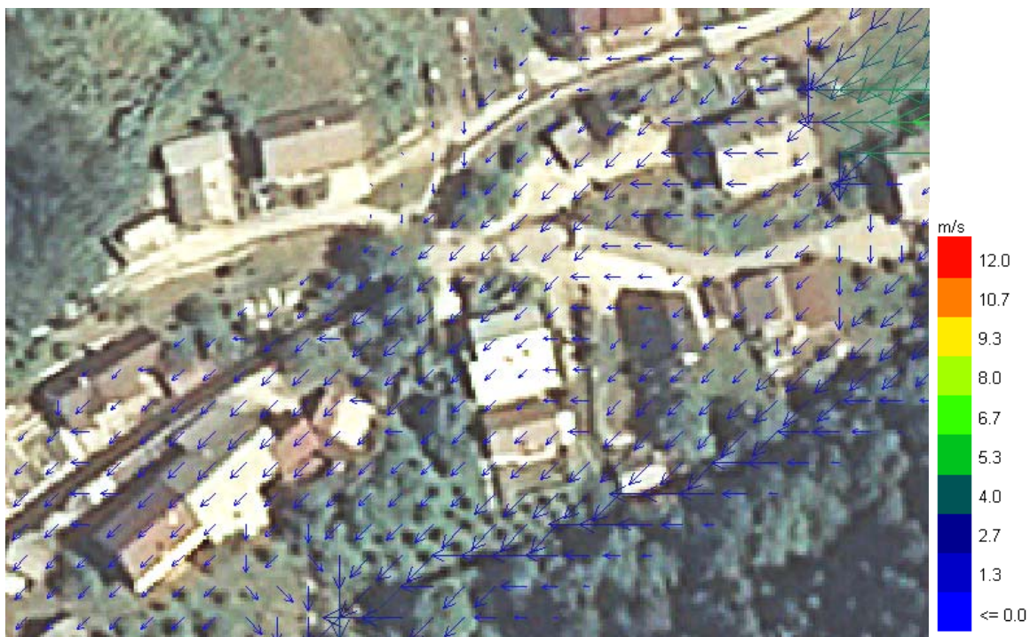
Slika 79: Podrobnejši prikaz izračuna maksimalnih hitrosti (vektorski prikaz) drobirskega toka pri modelu Bela19 (parametri: glej sliko 75).
