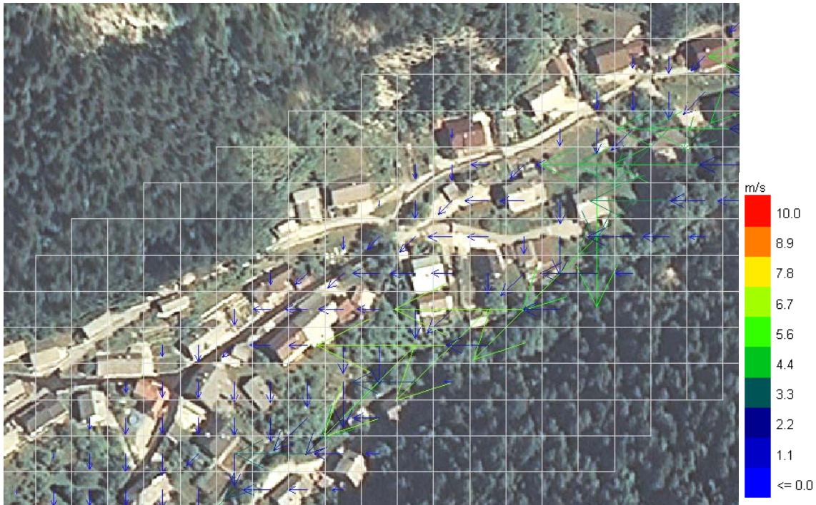
Slika 67: Detajl izračunanih hitrosti (vektorski prikaz) pri računski mreži 15m x 15m (Bela14, hidrogram Q_{100} , C_v = 0,42 ).
