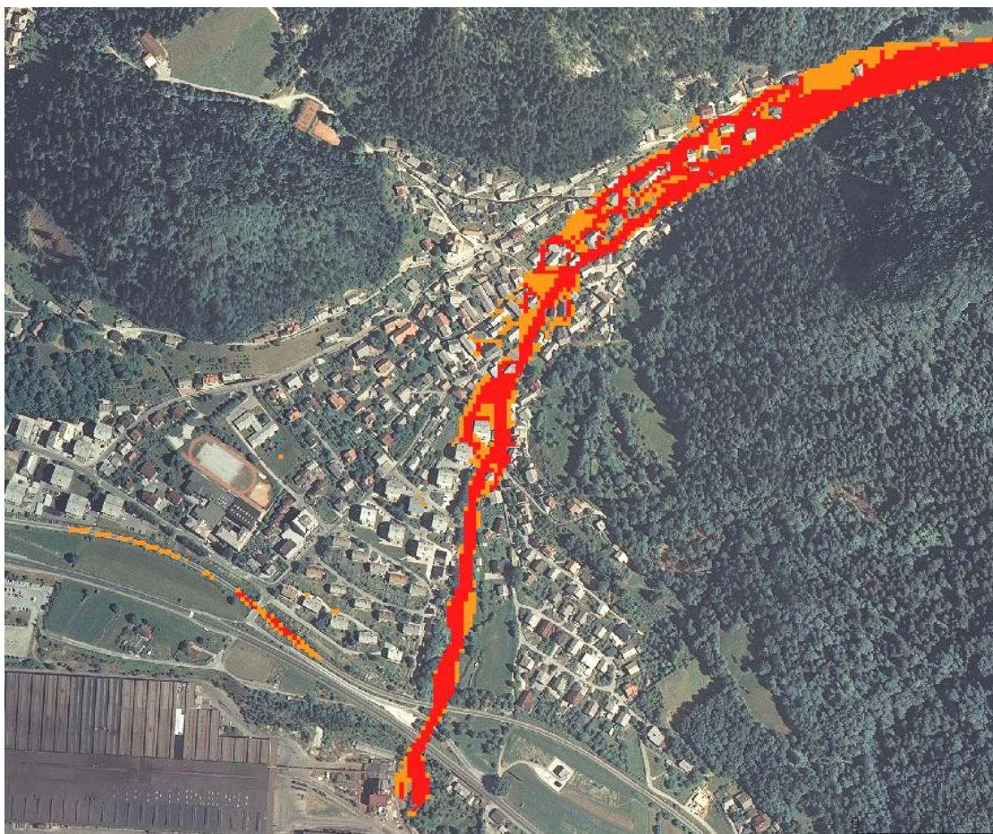
Slika 118: Karta nevarnosti pri modelu Bela20 (rdeča barva – velika nevarnost, oranžna barva - majhna nevarnost).
