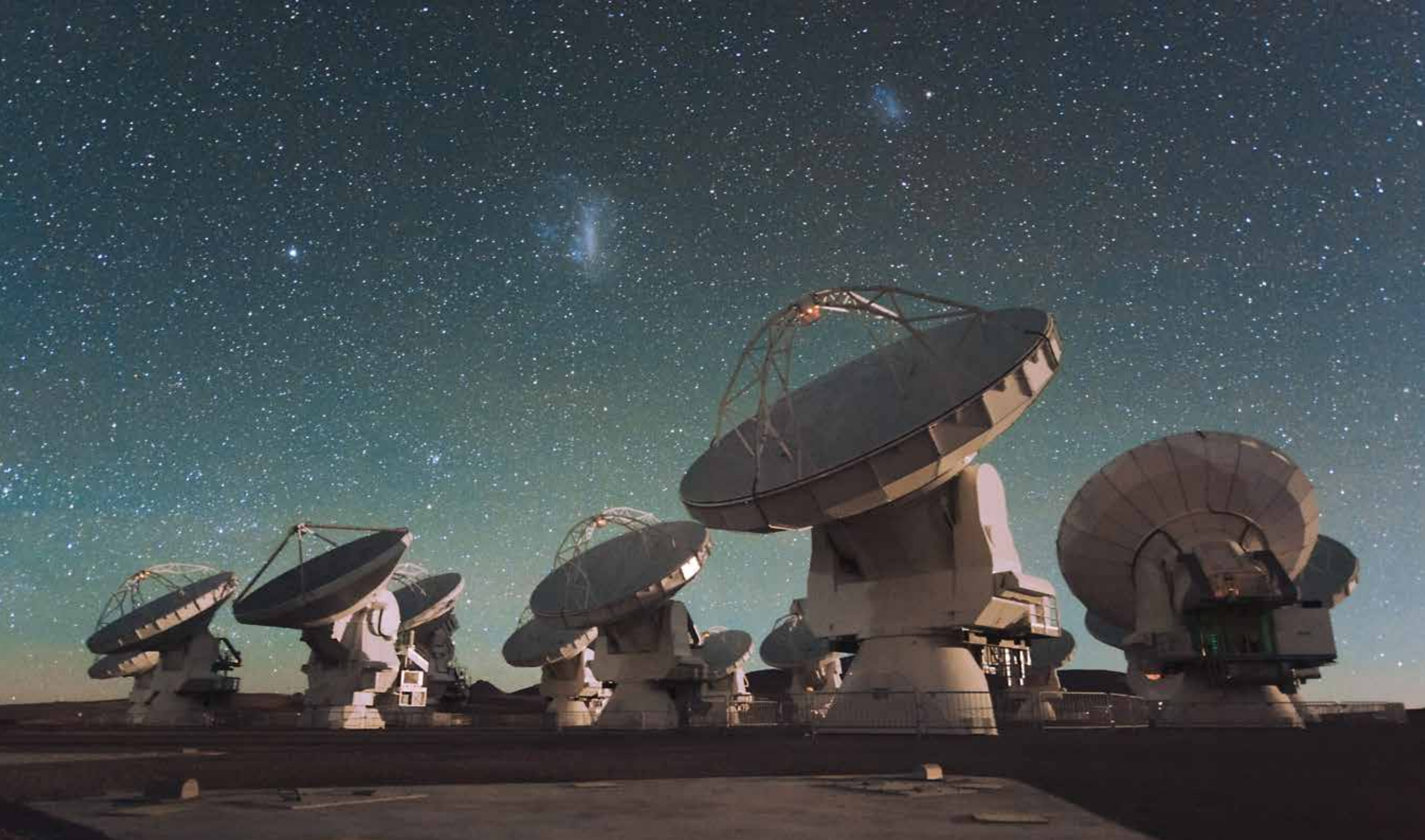
Skupina anten, ki so del radijskega teleskopa ALMA (Atacama Large Millimeter Array, Velika milimetrski mreža Atacama). Teleskop je sestavljen iz množice manjših teleskopov z obliko krožnika, ki zaznavajo milimetrski radijske valove. Zaznava lahko radijske valove s frekvencami od petintrideset do devetsto petdeset gigahercov. Pri tako visokih frekvencah elektromagnetnega sevanja je absorpcija sevanja v ozračju, predvsem zaradi prisotnosti vodnih molekul, zelo velika. Zato so astronomi izbrali puščavo Atacama v Čilu kot idealni kraj za postavitve tega teleskopa. Puščava Atacama se nahaja na nadmorski višini dva tisoč petsto metrov in velja za najbolj suho območje na Zemlji. Foto: ALMA (ESO/NAOJ/NRAO).
