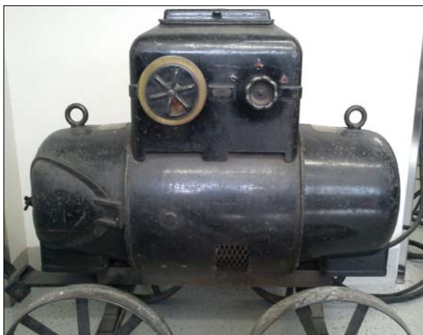
Varilni agregat za ročno obločno varjenje Kjellberg
