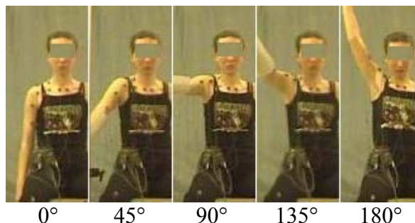
Slika 2.3: Meritev lastnega gibanja ramenskega obroča glede na orientacijo nadlakti: 0^\circ , 45^\circ , 90^\circ , 135^\circ in 180^\circ ; v ravnini, zasukani za 45^\circ pred telo
