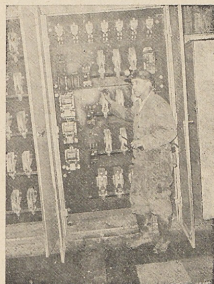
Viki Juvan, električar, pri pospeševalnih kontaktih izvozne naprave v Koepe v strojnici jaška Vine. Foto inž. T. Bregant
