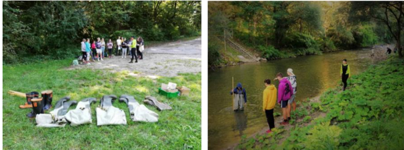
SLIKA 6: Meritve volumskega in masnega pretoka na reki Kokri.
