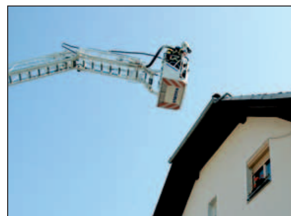
Za reševanje na višini upravljata pomik lestve gasilca v sami »košari« na lestvi sami.
