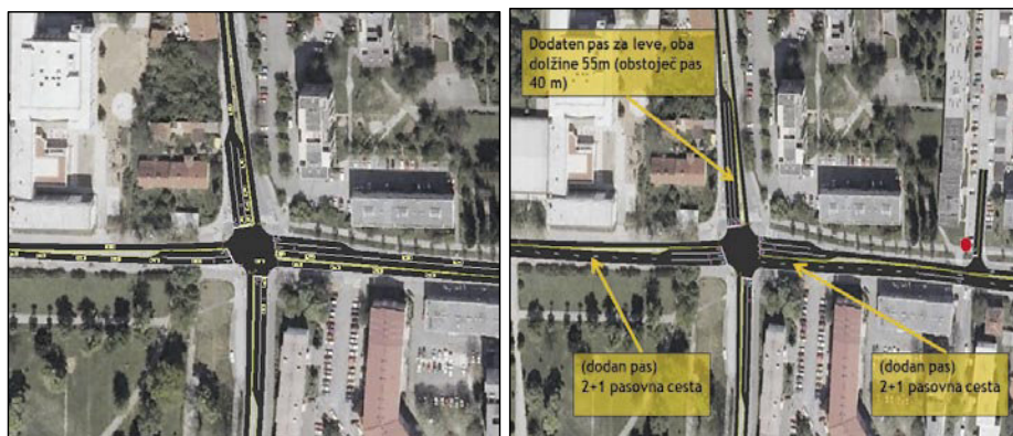
Slika 1 • Primerjava stare in nove geometrije semaforiziranega križišča (izsek iz programskega orodja Synchro)
