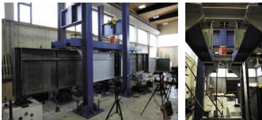
Slika 2 • Pogled na testni nosilec v preizkuševalnem okvirju
