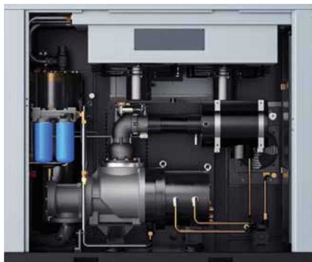
Slika 1 : Vijačni kompresor VDM 55E - pogled v notranjost
