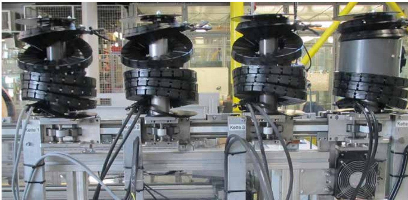
Slika 1: Energijske verige twisterband® s kabli chainflex® na preizkusu v igusovem® testnem laboratoriju
