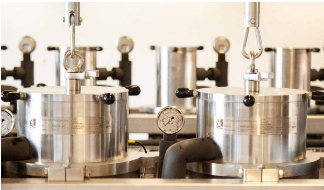
Sistem za ekstrakcijo s CO 2 , ki ga je v Sloveniji kot prvo kupilo podjetje PharmaHemp. Gre za postopek pridobivanja ekstraktov in učinkovin s pomočjo plinov v super- oziroma subkritičnih pogojih. Foto: arhiv SK Škrli.
