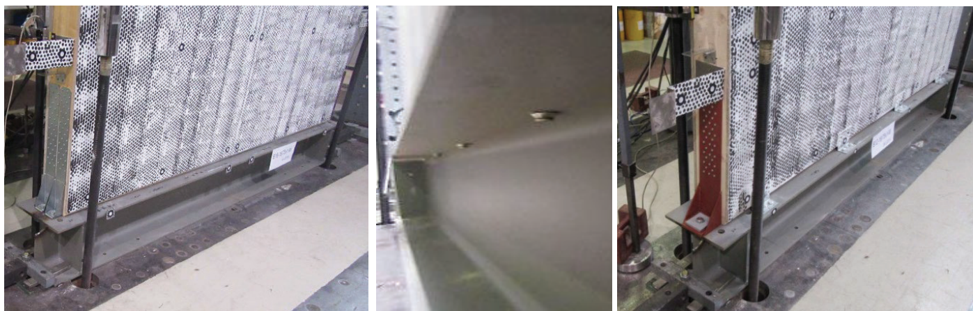
Slika 3 • Detalj pritrditve preskušancev z dviznimi kotniki (levo) in vijaknimi spoji spodnje prečke okvirja preko pasnice jeklenega profila (sredina), vpetje panela B12-16/75x1/M z močnejšima dviznima kotnikoma ob straneh in strižnimi kotniki na enakomernih razdaljah vzdolž ene strani panela (desno).
