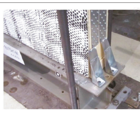
Slika 10 • Primerjava horizontalne sile v odvisnosti od pomika vrha panela monotonih strižnih preskusov (levo) ter pretrg dvižnih kotnikov pri preskusu B16-16/M (desno).
