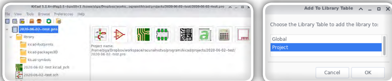
Slika 3: (a levo) Glavno okno programa Kicad zazna projektne podmape in (b desno) okno namenjeno izbiri tabele za shranjevanje povezav do knjižnic
