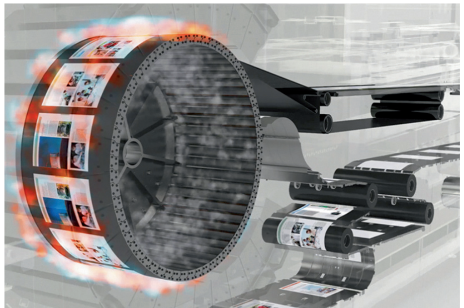
S posebnim sušilnim bobnom so v Canonu skrajšali sistem Varioprint I300 na tretjino prvotne dolžine.
