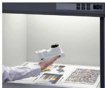
Spektrodensitometer FD-7 omogoča tudi vrednotenje osvetljenosti in barvne temperature svetlobe v prostoru ali svetlobni komori.
