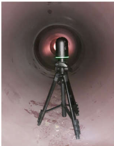
Slika 2: Terestrični laserski skener Leica BLK360 med izmero.
