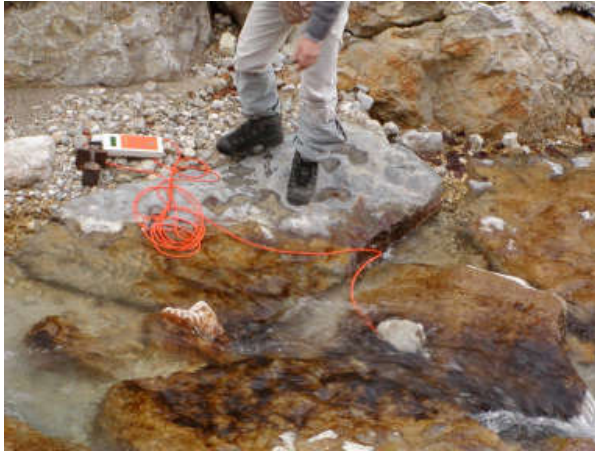
Slika 9 – Merjenje pretoka z metodo razredčenja
