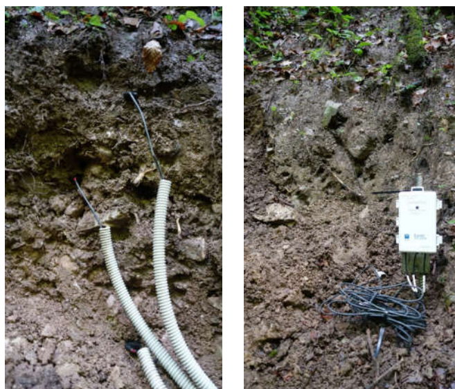
Slika 22 – Senzorji za merjenje vsebnosti vlage v tleh pred zasutjem profila (levo) in zapisovalnik podatkov s senzorjev (desno).
