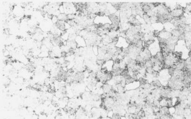
Slika 3: Mikrostruktura jekla 10CrMo 910 iz visoko popuščene martenzita (400 x)
