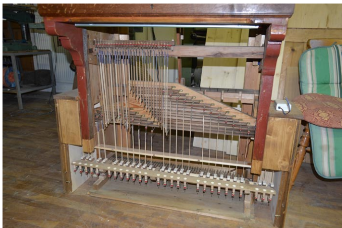
Sl. 7. Obnova pedalne mehanike. (bk)
