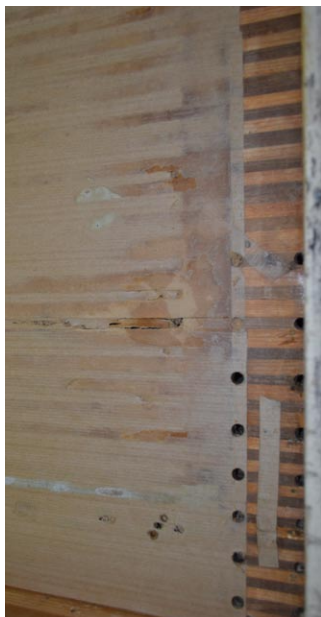
Sl. 3. Membrane (mešički) in dno sapnice po odstranitvi membran. (bk)
