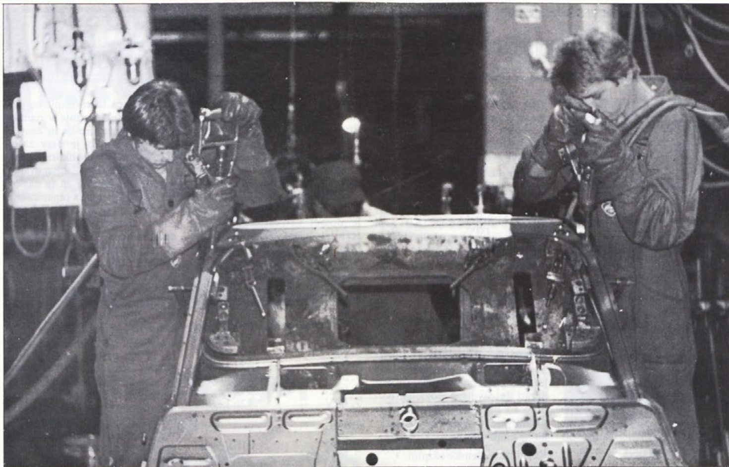
Delo na glavni sestavi R 4: tu dobi „katrca“ vse štiri stene in streho, nato gre na tekoči trak, kjer jo s točkovnim in kolutnim varenjem dokončno zvarijo, ji dodajo vsa vrata ter pokrov motorja, na koncu traka pa jo še poobdelajo. Kontrola jo nato še dobro in temeljito pregleda in karoserija se dvigne na viseči tekoči trak ter gre v lakmnico. — Foto: Polde Miklič, proizvodnja III.
